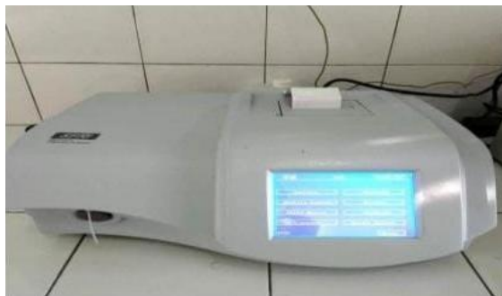
Gambar 2.4. Alat spektrofotometer SFRI BSA-3000 Sumber :(Fajarnah et al., 2024)
